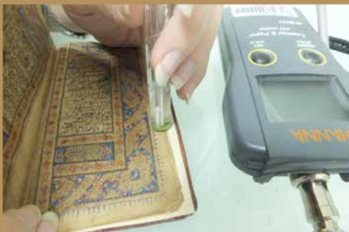
إجراء قياس الحموضة على إحدى المخطوطات pH measurement on a manuscript
